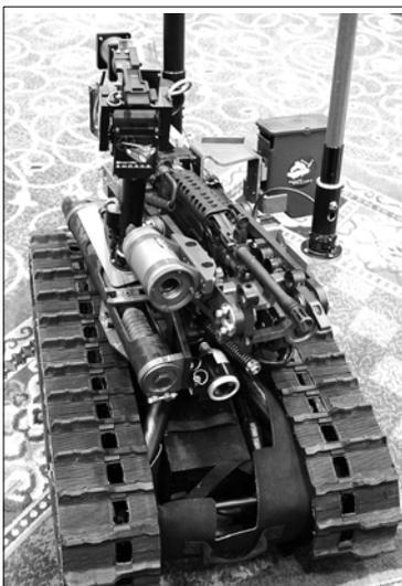
SWORDS (Special Observation Reconnaissance Detection System) Kampfroboterversion eines Detektionsfahrzeugs (Kamera, Sensoren, wahlweise MG/Granatwerfer oder Panzerabwehrkanone)
