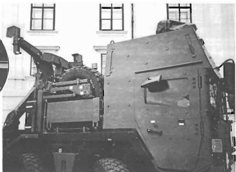
ÖBH gehärteter LKW MAN 38.440 mit Hackensystem für Transport von Containern und Abrollbehältern Bild: Archiv betrifft Frieden
